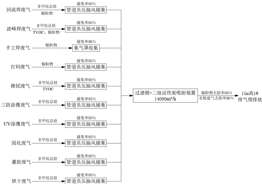
图 4-1 本项目废气收集方案示意图
