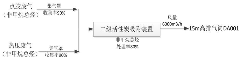
图 4-1 废气处理工艺示意图
